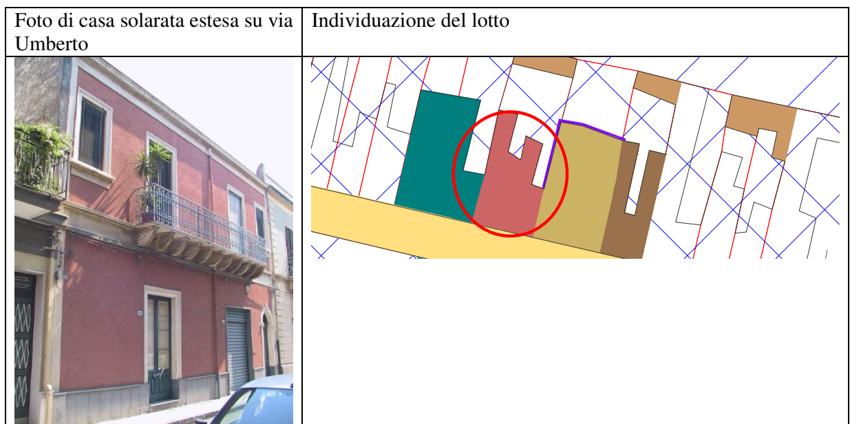
Figura 5 -- casa solarata estesa tipo del tessuto A L5 . Superficie del lotto pari a 438mq; larghezza su fronte stradale pari a 12m; rapporto di copertura pari a 50%; rapporto di permeabilità pari a 0%; altezza dell'edificio su fronte stradale pari a 8m, Iff 4mc/mq
